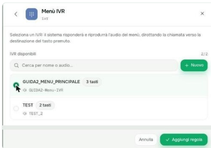
Fig. 6.2 — L'elenco mostra per ogni menu quanti tasti ha e quale audio riproduce: due informazioni che bastano a riconoscere quello giusto.
